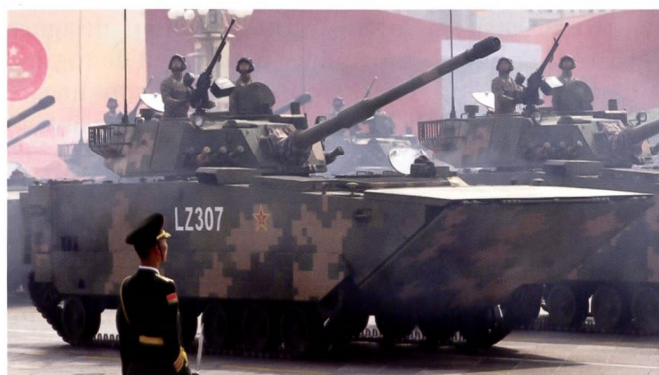
Le ZBD-05 amphibie est employé par des unités de l'armée de Terre comme de la Marine. Il est équipé d'une tourelle de 105 mm et peut également engager des missiles antichars. L'engin du haut est vu dans la livrée portée par les unités de Marine.
