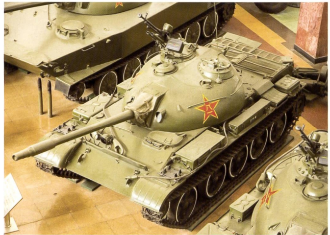
Le Type 62 est une version en taille et en poids réduits du Type 59.
