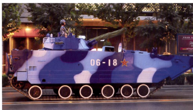
Le ZBD-05 amphibie est employé par des unités de l'armée de Terre comme de la Marine. Il est équipé d'une tourelle de 105 mm et peut également engager des missiles antichars. L'engin du haut est vu dans la livrée portée par les unités de Marine.
