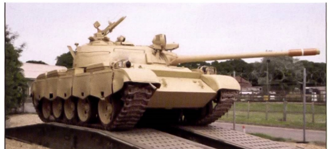
Le Type 69 se distingue de son prédécesseur par la longueur de sa carcasse, ainsi que par ses optiques de vision nocturne infrarouge.
